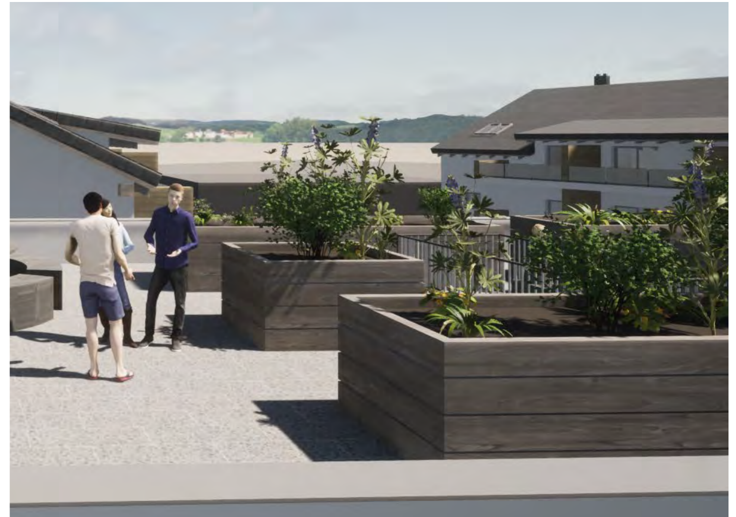
Hochbeete und Beschattung Material: Holz Fichte Verlegeart: horizontal Höhe: 80 cm
