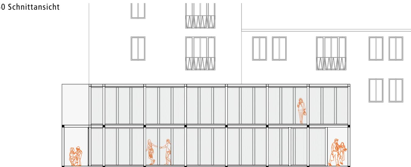
Die Holzkonstruktion wird innerhalb des Bestandes angeordnet und es bilden sich Regale aus, in dem die Gegenstände der BorrowBox Platz finden. Die abgehängte Decke im vorderen Gebäudeteil wird entfernt, und die Treppe wird zentral platziert. Die in die Konstruktion eingehängten Polycarbonat-Paneele ersetzen die bestehende Fassade der Liegenschaft.
